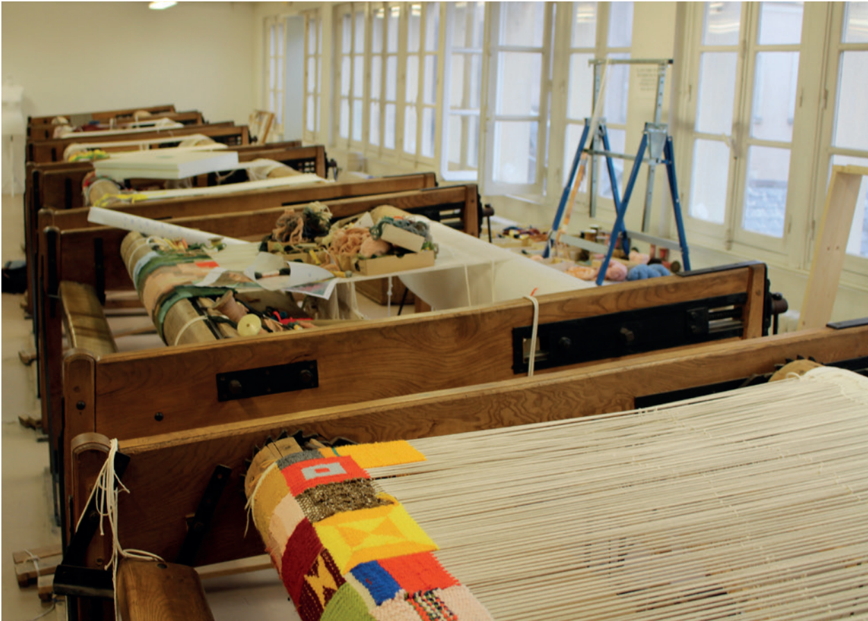
Les métiers de basse lisse pour la réalisation des tapisseries. © Philippe Nédélec / Conservation départementale du patrimoine.
